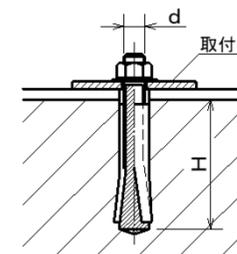
(あと施工金属拡張アンカーボルト: おねじ形)
