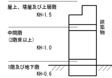
局部震度法による設計用震度 通常の建築設備
