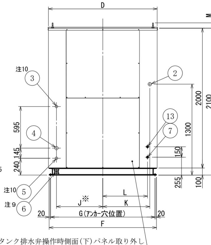
注9 タンク排水弁操作時側面(下)パネル取り外し
