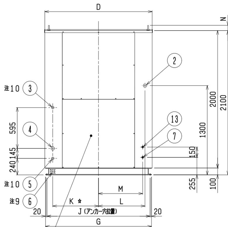
注9 タンク排水弁操作時側面(下)パネル取り外し
