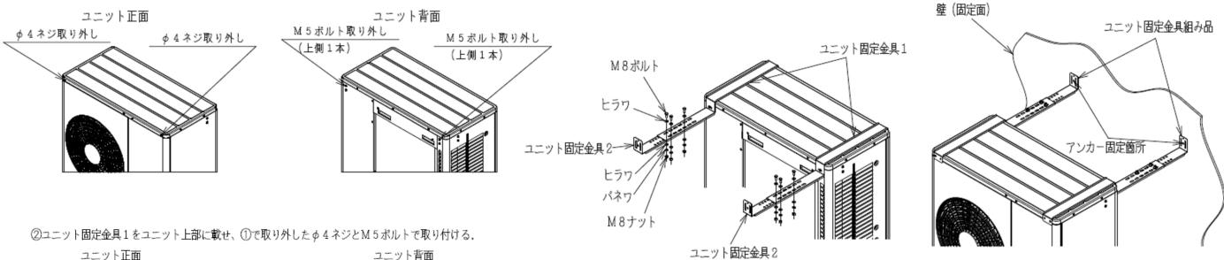
④ユニット固定金具組み品(2セット)をアンカーボルト(現地調達)で壁に固定する.
