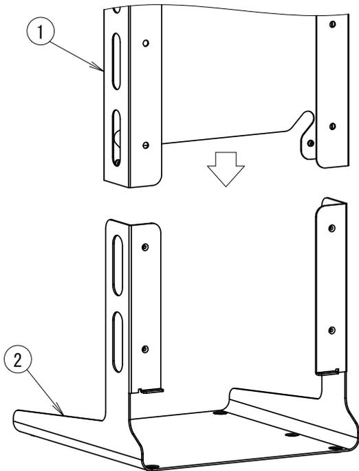
2. 付属品の固定ねじで離隔取付金具と床置金具を固定します。
