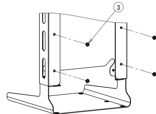
3. 床置金具をアンカーボルトで床面へ固定します。
