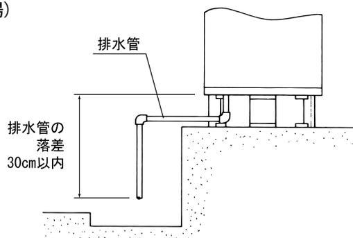
排水配管の落差が30cmをこえる場合は、排水バルブ下部30cm以内にホッパーを設け、大気開放になるよう排水配管してください。
