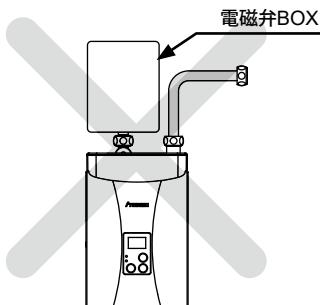
自動水栓用の電磁弁BOXと接続する場合はステンレスフレキ管(推奨50cm以上)を介して接続してください。
