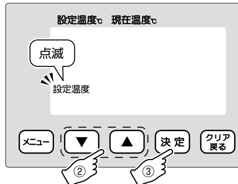
④ **▼** **▲** を押して、希望する沸かし上げ温度に合わせる。
