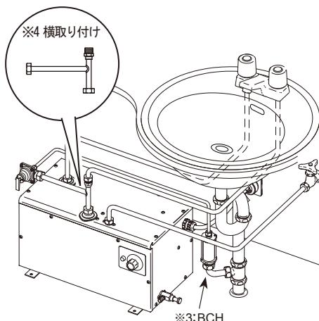
※1:袋ナットチーズの混合水栓給水口を使用しない場合は、砲金製またはステンレス製のキャップをしてください。
