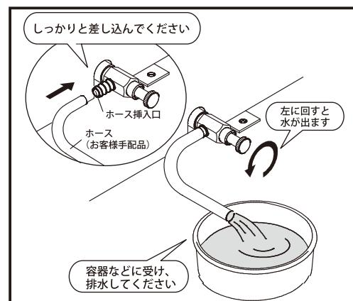
⑤排水が終了したら混合水栓を閉めてください。排水栓もツマミを回し完全に閉めてください。
