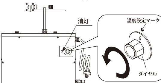
サーモスタッフダイヤルを左一杯に回し、通電ランプが消灯した状態であることを確認してください。
