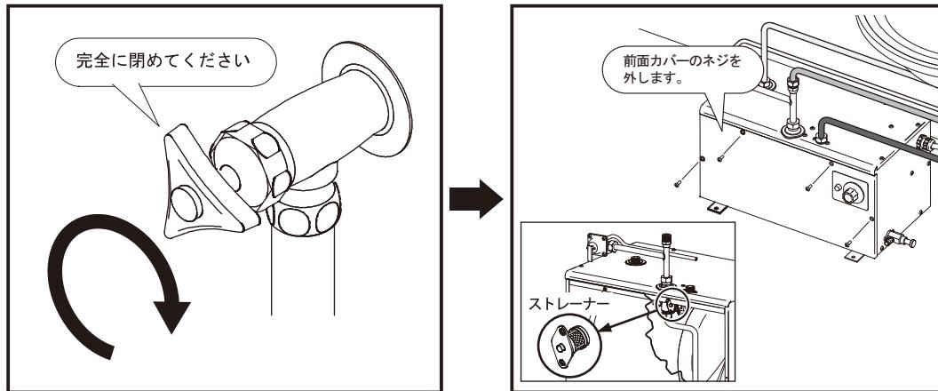
④ネジを外してストレーナーを取り抜き、フィルター部分に詰まったゴミをナイロンブラシなどで取り除きます。(注:ネジを外した時に少量の水が出ますので水を受けるものを用意してください。)
