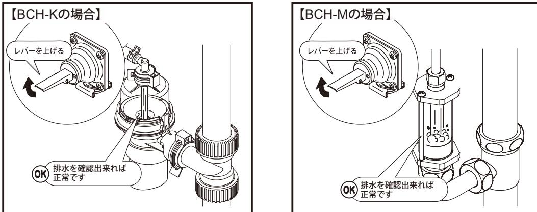
③排水が確認できたら必ず逃し弁テストレバーを下げる、排水が止まることを確認してください。
