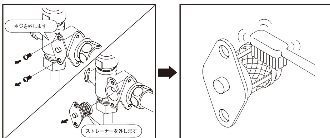
⑤ストレーナーの取り外しと逆の要領で取り付けた後、給水を行い、漏水がないか確認してください。漏水があった場合は再度取り付け直してください。(給水方法はP.16『温水器に給水する』参照)
