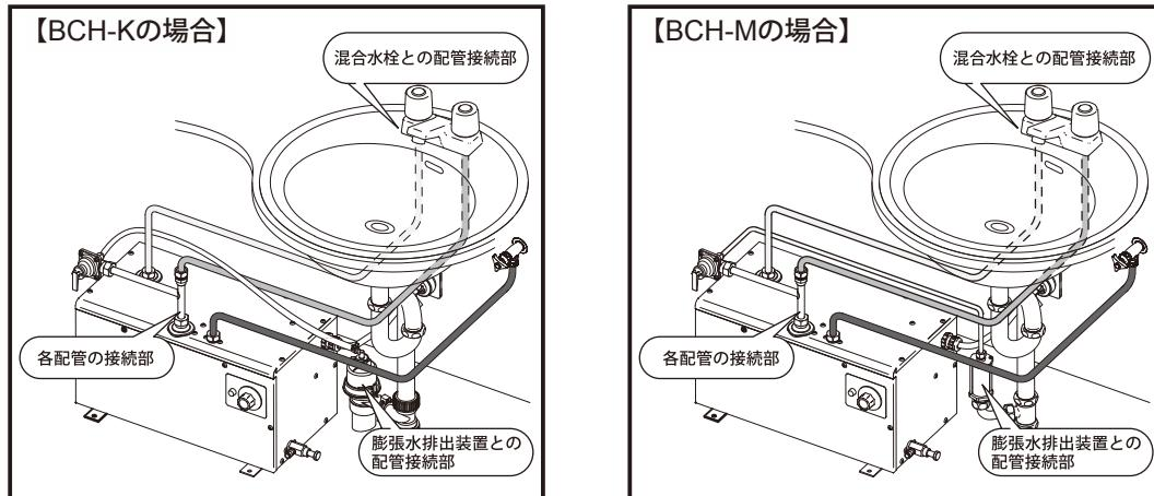
⑤逃し弁ストレバーを上げて、逃し弁が正しく作動するか確認します。
