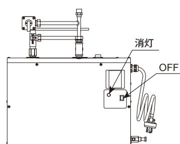
運転スイッチをOFFにし、通電ランプが消灯した状態であることを確認してください。
