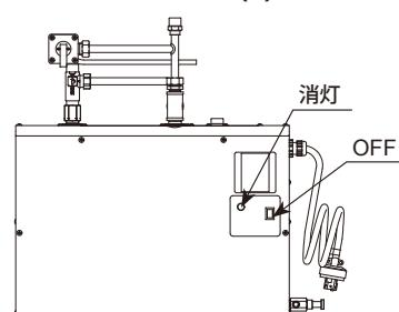
運転スイッチをOFFにし、通電ランプが消灯した状態であることを確認してください。
