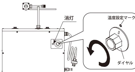
サーモスタットダイヤルが左一杯に回されており、通電ランプが消灯している状態であることを確認してください。
