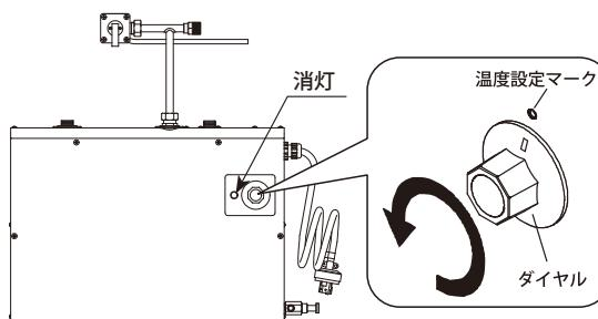
サーモスタットダイヤルを左一杯に回し、通電ランプが消灯した状態であることを確認してください。
