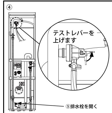
⑥排水が終了したら、混合栓・排水栓を閉めてください。逃し弁のテストレバーはご使用再開時まで上げたままにしてください。
