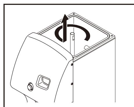
⑨排水が終了したら、取り外した時と逆の要領で部品を取り付けて作業完了となります。
