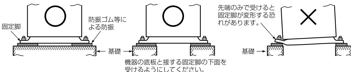
機器の底板と接する固定脚の下面を受けるようにしてください。
