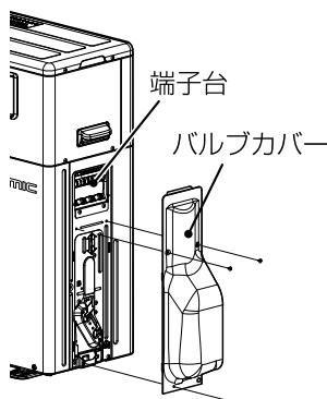
2.電源線の先端を端子台の電源表示「R」、「S」、「T」にねじ止め固定します。間違いないよう接続してください。(右図を参照)
