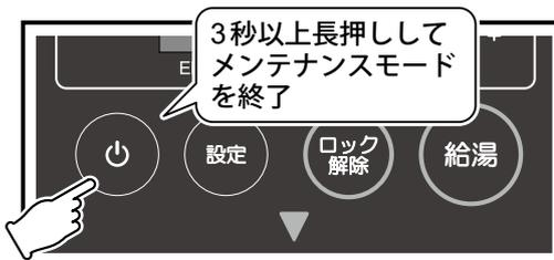
本体フラッシング作業が完了した後は「運転スイッチ」を3秒以上長押しして通常運転を開始してください。
