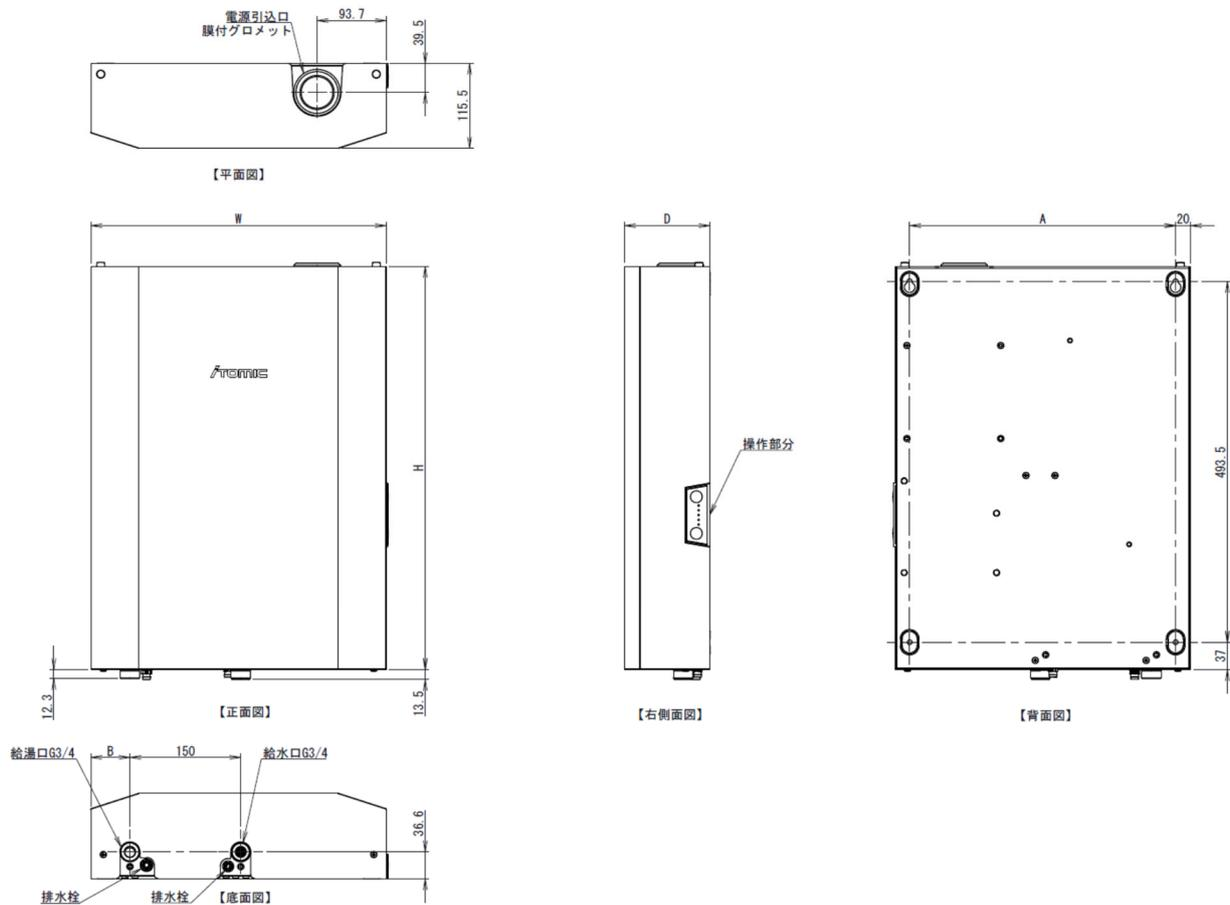
※排水栓はホース口です。本体の湯水を抜く際に使用します。常時排水に繋ぐ必要はございません。同梱の安全弁は給湯配管側に施工し、吹出し口は、間接排水処理をしてください。
