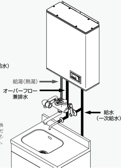
※水道直結でのご使用の場合は専用の熱湯専用単水栓 (NT-2) をご使用いただくか、もしくは密閉型給湯器ESD+MZ-N3Pの組み合わせでのご使用ください。(右図参照)
