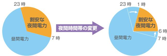
リモコン操作により沸かし上げ時間帯を変更できます。電気料金メニューを変更しても、割安な夜間電力の時間帯に沸かし上げ時間帯を変更できるので経済的です。
