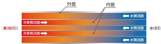
多重管式ガスクーラ断面図
