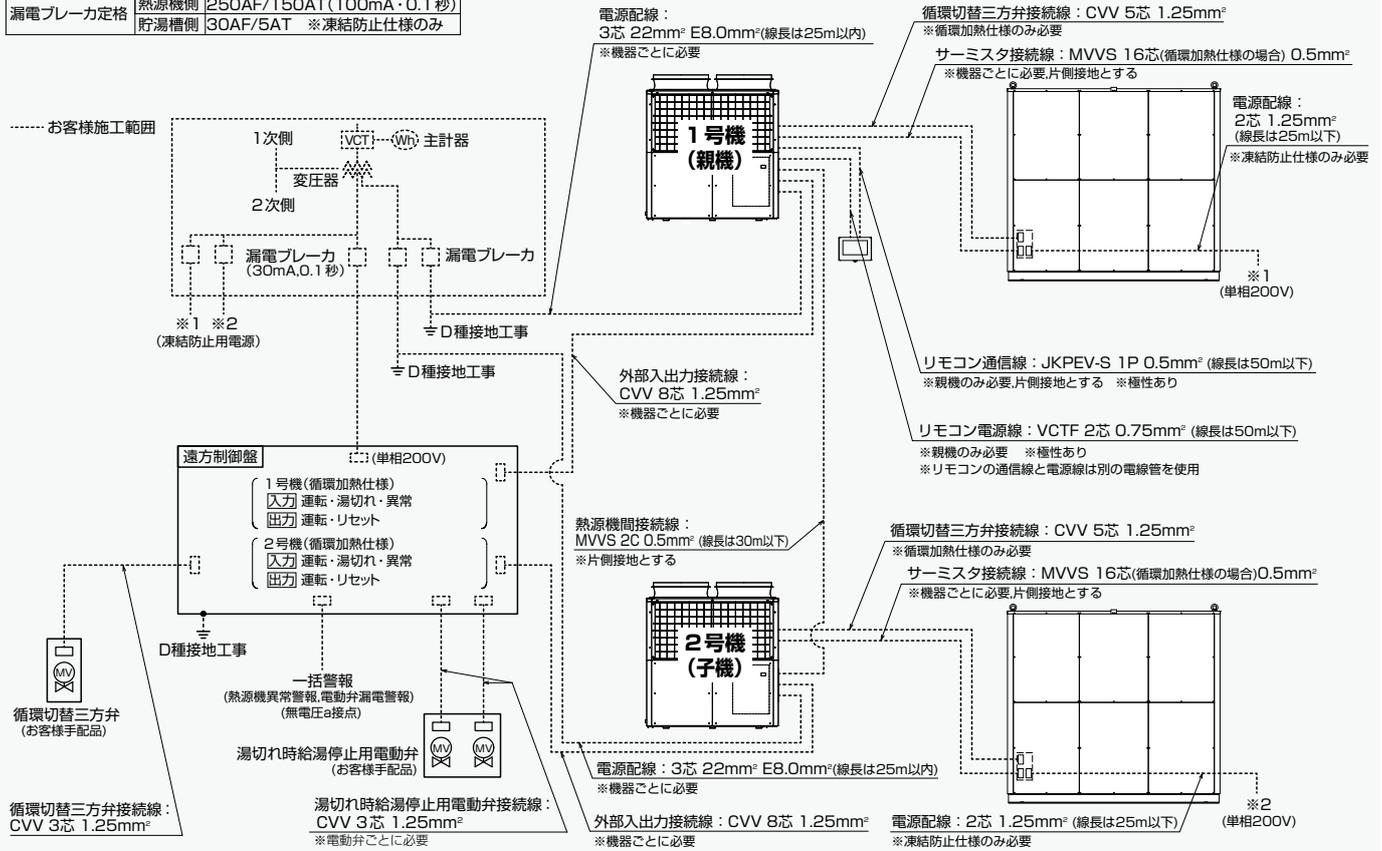
Yフレーム 電気配線施工例(横型高圧タンクの場合) ※給湯停止用電動弁内蔵型。詳細配線は除く
