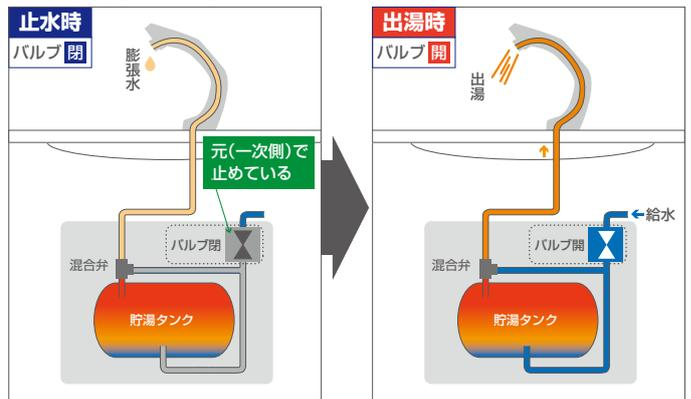
先止め式とは、電気温水器の出湯側(二次側)のバルブの開閉によって給湯する方式です。給水圧力を減圧弁で減圧し、膨張水を逃し弁から排出処理する必要がありますが、水栓からの滴下がありません。また、水栓の選択は自由です。当社の先止め式電気温水器「ESW03」で自動水栓を利用する場合、電磁弁などの制御機能部を別に用意し、出湯側に取り付ける必要があります。
