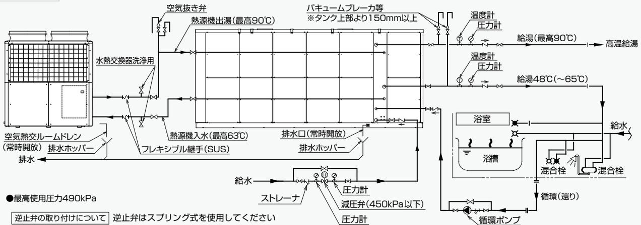
循環加熱仕様 2台設置(横型高圧タンクユニット※を使用した場合)※給湯停止用電動弁内蔵型
