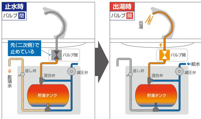
元止め式 (ESWM3) 給湯のしくみ (自動水栓接続時のイメージ)
