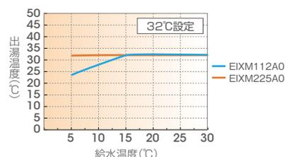
★2 アイコンで表した機能・特長に関する注意事項: ■ 瞬間式のため沸上温度を設定しても流量が加熱能力を上回った場合には湯温を保てない場合があります。詳細は上図出湯能力グラフ参照。
