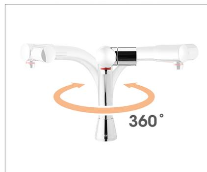
水栓本体は360°回転します。出湯位置に制約を受ける場合でも対応しやすい設計です。背面の六角穴付き止めねじを締め付けることで首振りをロックすることが可能です。
