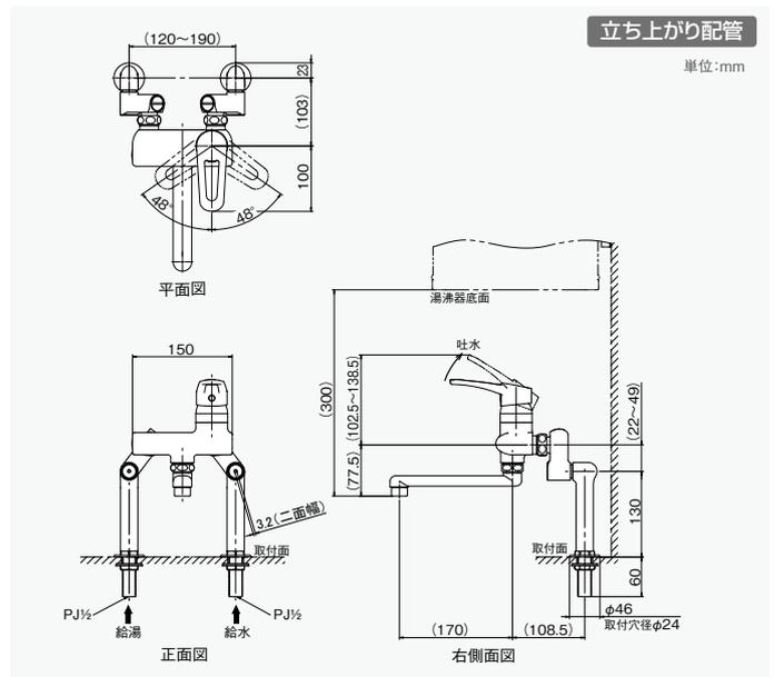
※: Eタイプは節湯対応型です。Eタイプの混合レバーハンドルの可動範囲は、湯側50°水側35°となります。
