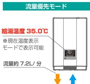
流量優先を選択すると、給水温度に関わらず設定した流量を保ちます。給湯温度は下がりますが、流量を減らしたくない場合に適しています。
